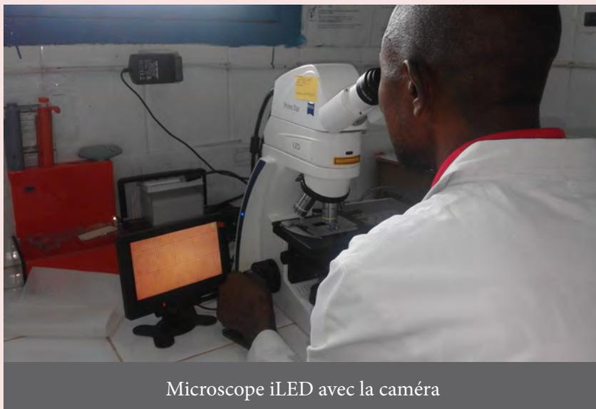
Microscope iLED avec la caméra
