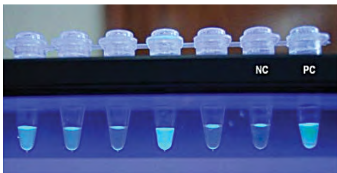
Figure 2: Un test positif émet une fluorescence verte. PC: contrôle positif, NC: contrôle négatif (Photo reproduite avec la permission du Dr. Enock Matovu)
