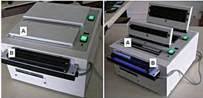
Figure 1: Incubateur Loopamp™ LF-160 utilisé pour le test LAMP. Après extraction de l'ADN, la réaction LAMP est effectuée dans le bloc de réaction (A), calibré pour maintenir une température constante de 65°C et arrêter la réaction au bout de 40 minutes. Les résultats sont visualisés sous diodes électroluminescentes (lumière LED) (B).
